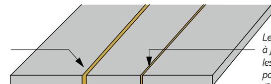
Le produit est inséré à joint vif entre les deux revêtements pour assurer la soudure (SG 916)
