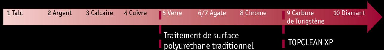
L'échelle de Mohs détermine la résistance à la rayure des matériaux des plus tendres aux plus durs.
